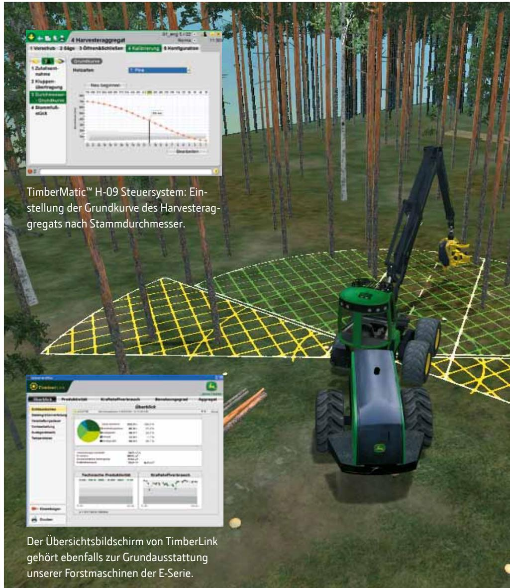
TimberMatic™ H-09 Steuersystem: Einstellung der Grundkurve des Harvesteraggregats nach Stammdurchmesser.
