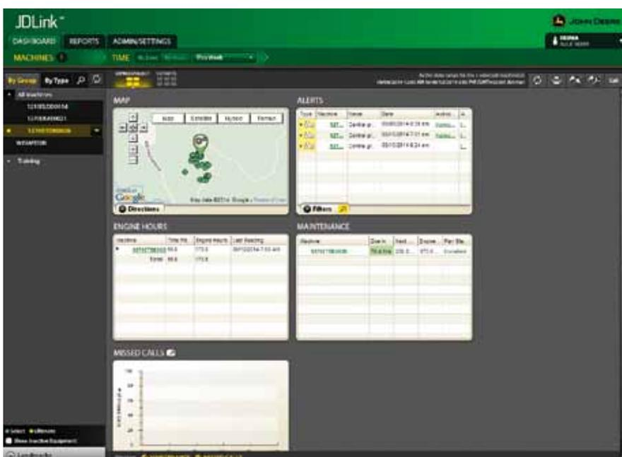
Die Maschinen können gruppenweise, einzeln oder in einer Gesamtübersicht angezeigt werden. Die Maschinendaten können nach Datum, Zeitraum und Motorbetriebsstunden sortiert werden. Die JDLINK Maschinen- und Flottenmanagement-Lösung gibt es für John Deere EPA Interim Tier 4 (IT4) EU Stufe IIIB Forstmaschinen. Für ältere Modelle der E-Serie wird ein JDLINK-Nachrüstset angeboten.
