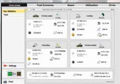
TimberLink F ist ein Tool zur Überwachung der Rückzugleistung nach folgenden Arbeitsschritten: Leerfahrt, Beladen, Beladene Fahrt und Entladen.
