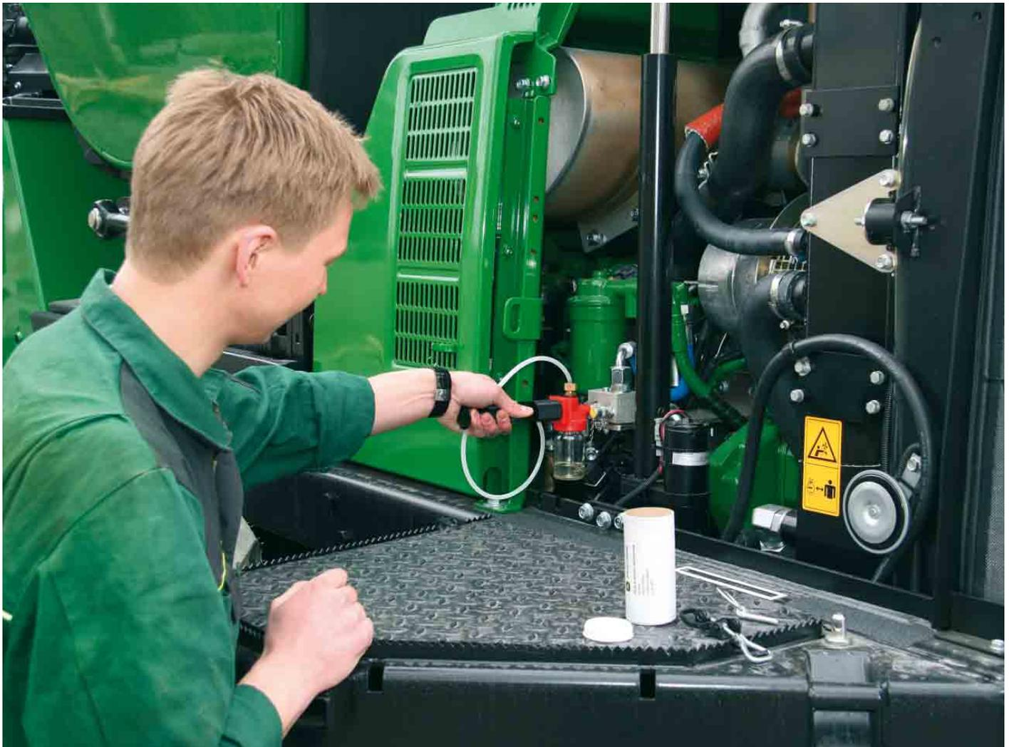
Die regelmäßige Ölprobenentnahme und -analyse ist zusammen mit dem TimberLink Programm ein ausgezeichnetes Instrument für die Überwachung des technischen Zustands und die auf präzise Messdaten beruhende Wartung Ihrer Maschine. Dadurch erhöhen Sie die Betriebszuverlässigkeit Ihrer Maschine und senken Ihre Wartungs- und Betriebskosten. Die Ölproben lassen sich an unseren Forstmaschinen der E-Serie schnell und bequem entnehmen.
