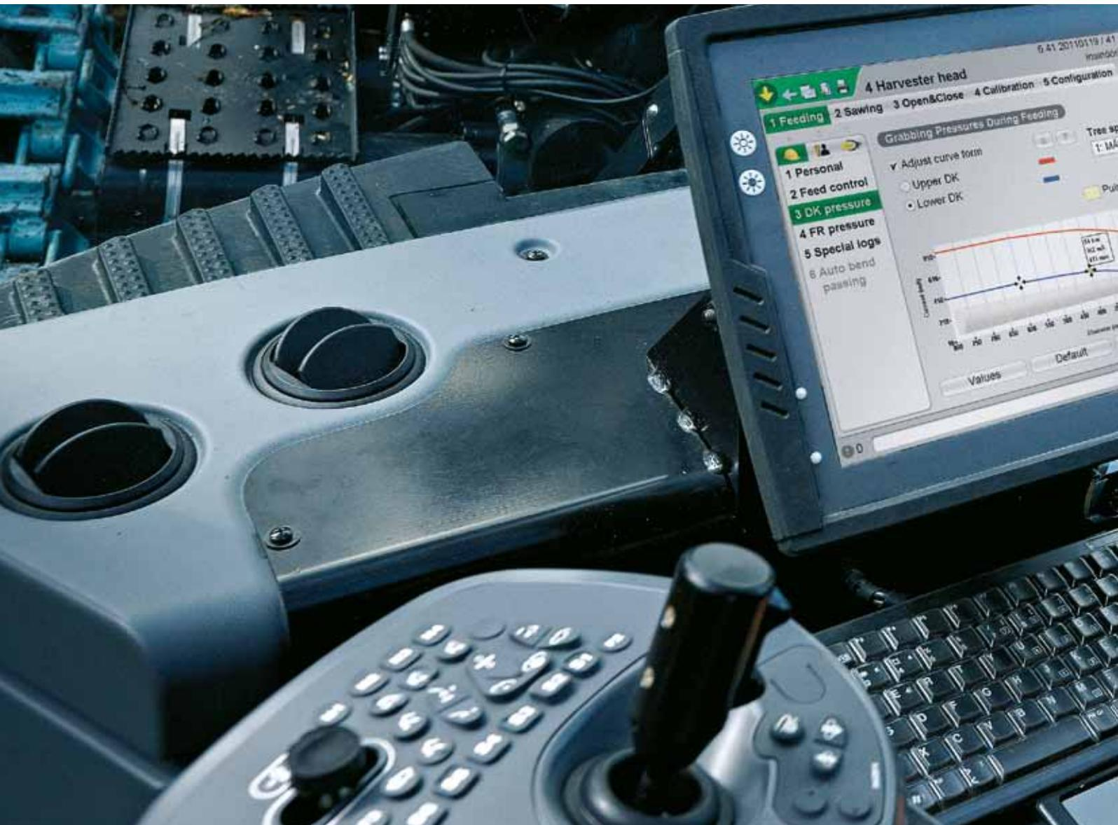
TimberMatic H-09 ist ein für unsere Harvester der E-Serie entwickeltes zuverlässiges und anwenderfreundliches Steuersystem. Über ein und dieselbe Schnittstelle ermöglicht es die sichere Steuerung der Basismaschine, Messsysteme und des Harvesteraggregats.
